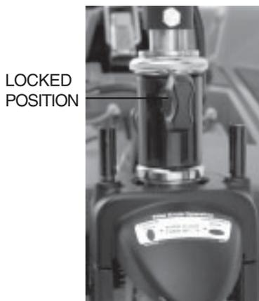
FIGURE 16. TILLER LOCK (LOCKED)
